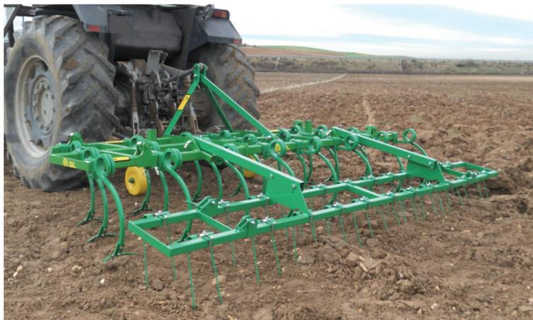
Les vibroculteurs GIL fabriqués avec bras porteurs élastiques, en acier spécial sur châssis 60x60 en aciers de très haute qualité garantit au vibroculteur une grande fiabilité et une longue durée de vie.
