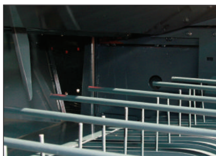
Ouverture d'alimentation agrandie pour incrémenter les volumes de produit dans la chambre de compression et augmenter la production de balles per heure
