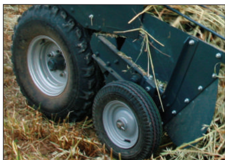
Roue de support du ramasseur pour les champs plus difficiles
