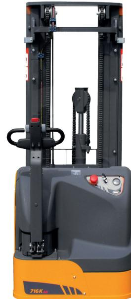
La maintenance est facilitée par une grande ouverture dans le châssis qui permet de remplacer la roue de traction sans avoir besoin de soulever tout le chariot. Les nouvelles couvertures en polyéthylène avec système d'ouverture facilitée permettent un accès maximal à tous les composants dans les opérations de maintenance ordinaire et extraordinaire.
