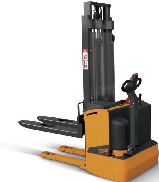
Le compartiment batterie est accessible en soulevant simplement le capot à charnières ce qui facilite les contrôles périodiques et la recharge de la batterie. Le Focus ac est disponible avec des batteries jusqu'à 375 Ah. Le chargeur de batterie wo-wa embarqué (en option) permet de recharger dans toutes les prises de courant.
